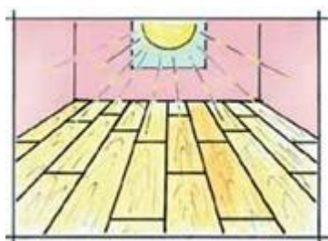
Asenna laudat päävalon suuntaisesti.
